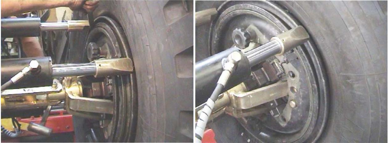
**6.12)** Ruotare il telaio verso l'esterno agendo sul comando A2, (rif. pag. 2) in maniera da liberare il pneumatico montato, togliere la flangia dal cerchio.
