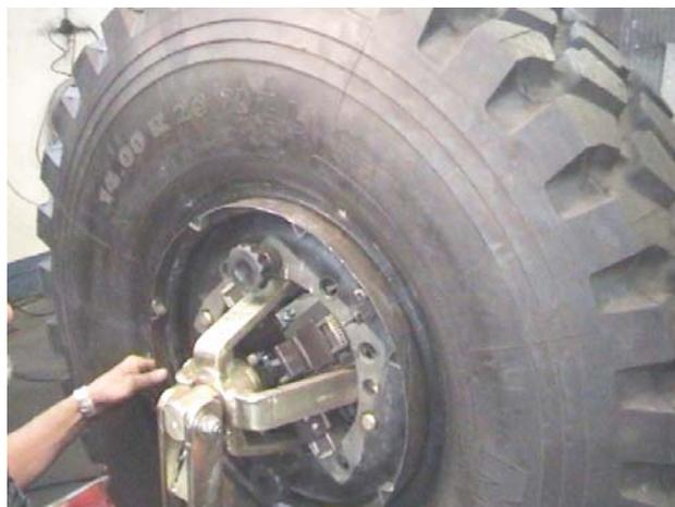
**6.8)** Montare l'anello di tenuta in gomma facendo attenzione ad inserirlo correttamente contro il pneumatico per aumentare la tenuta. Montare di seguito l'anello bordo cerchio.
