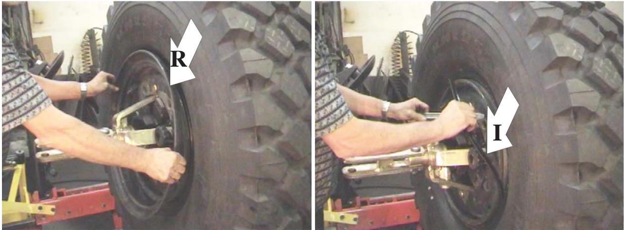
5.9) Utilizzando il disco stallonatore della macchina, stallonare il pneumatico in maniera da smontarlo dal cerchio.
