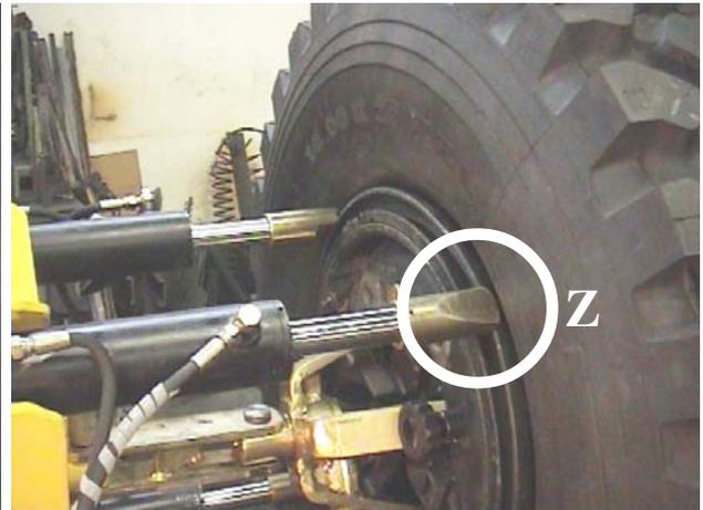
5.5) Ruotare il pneumatico fino alla posizione nella quale l'anello molla ha la gola in alto posizionato fra i due cilindri, come in foto.
