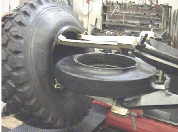
6.2) Inserire all'interno dell'anello i cilindri per la deformazione dell'anello stesso e azionando il comando B2 (rif. pag. 2) allargare l'anello in gomma. Utilizzando la fascia in dotazione agganciare i cilindri e l'altro capo della fascia al telaio dei cilindri stessi.
