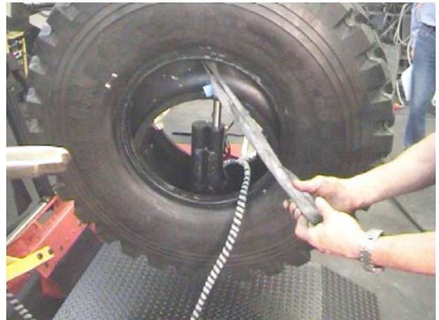
**5.13)** Posizionarsi con il telaio nei pressi del pneumatico, assicurare la fascia al perno del supporto cilindri e, azionando il comando **A2** (rif. pag. 2), allontanarsi lentamente ed a tratti dal pneumatico estraendo in questo modo l'anello in gomma.
