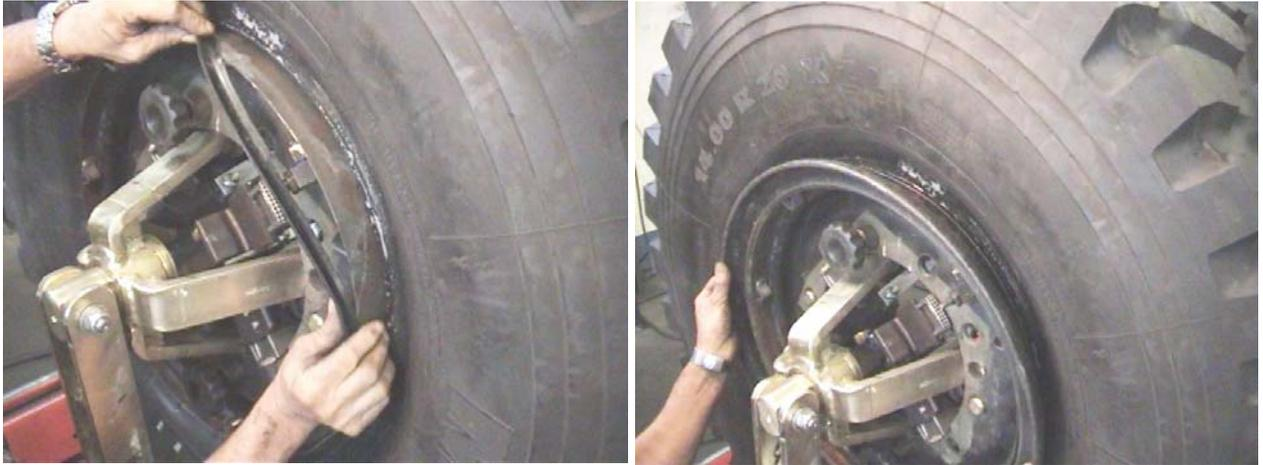
**6.9)** Posizionare l'anello molla fra i 4 pistoni del telaio e utilizzando il comando A1 (rif. pag. 2) ruotare il telaio verso il pneumatico e bloccarlo sulla flangia della ruota attraverso il perno.
