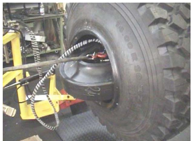
**6.4)** Riportare i cilindri in posizione iniziale fig. 2 (completamente chiusi) e ruotarli di 90° fig. 3 all'interno dell'anello in gomma. Agendo sul comando **B2** (rif. pag. 2) allargare i cilindri fig. 4 in maniera da fare cadere l'anello all'interno del pneumatico.
