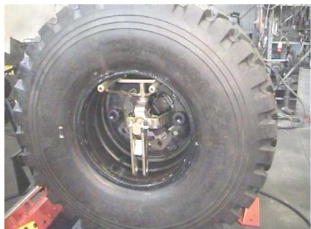
**6.6)** Utilizzando, prima i cilindri e poi il disco stallonatore, spingere il pneumatico completamente sul cerchio.
