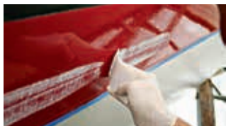
Spartling langs vandlinjebælte
