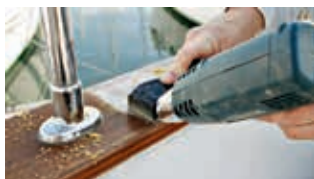
Fjern gammel lak med en varmpistol
